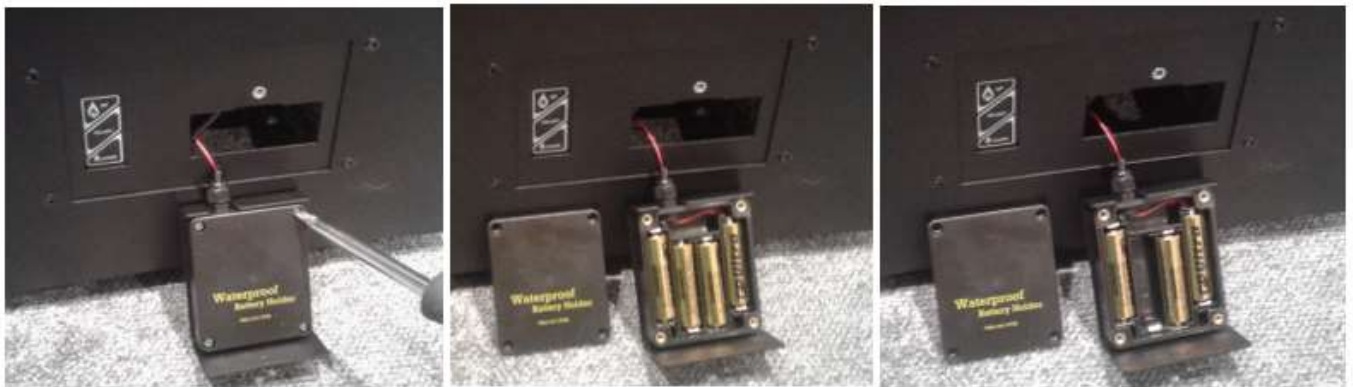
Foto 8: Batterientausch im Batteriebehälter
