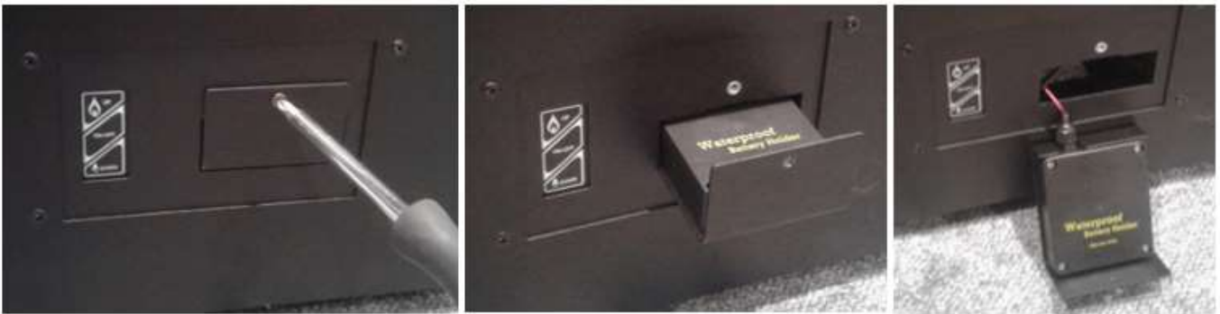
Foto 7: Herausnahme des Batteriebehälters
