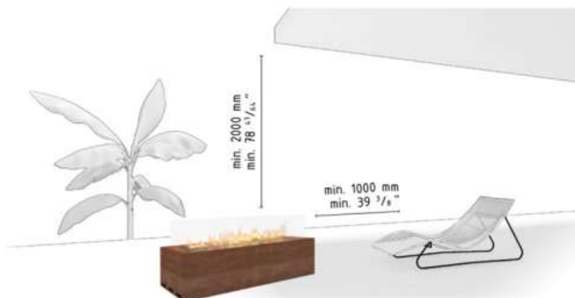
Abbildung 1: Mindestabstand zu brennbaren Materialien
